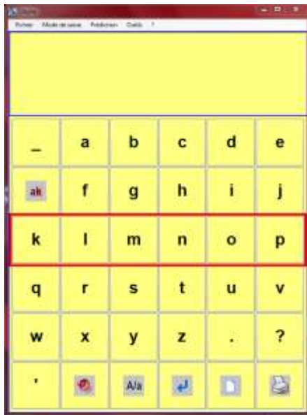
Deux configurations de Sibylle (à gauche : clavier de lettres avec défilement automatique lignes/colonnes et désignation avec contacteur / à droite : tableau de pictogrammes avec catégories et désignation directe)
