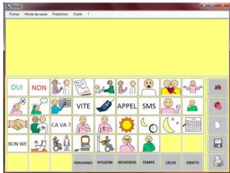
Deux configurations de Sibylle (à gauche : clavier de lettres avec défilement automatique lignes/colonnes et désignation avec contacteur / à droite : tableau de pictogrammes avec catégories et désignation directe)
